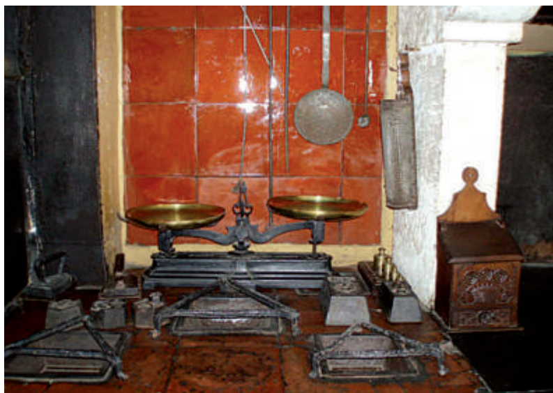
Balance à fléau ou trébuchet, montée sur un socle à vérins réglables, composée d'une colonne centrale avec fléau en fonte et deux plateaux en laiton doré.
