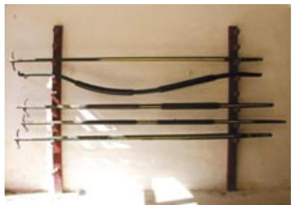
Timons du garage des Sabatier : le courbe était utilisé pour l'attelage en poste de la berline de voyage.
